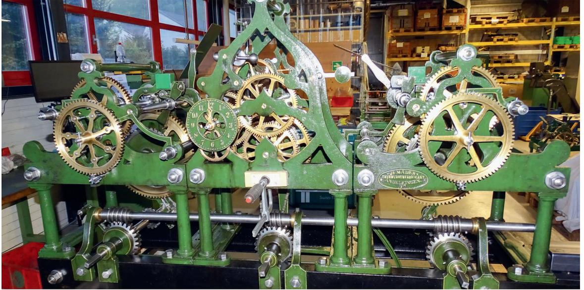
*Für die Revision wurde die Uhr im Turm abmontiert, nach Triengen in die Firma Muff transportiert, zusammengesetzt, revidiert und für den Rücktransport wieder in kleine Elemente zerlegt.*
